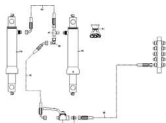
ЕТВ-0000003935, Гидравлическая схема DMC 9 м Super/XL сошники, гидравлические детали задняя навесная система
